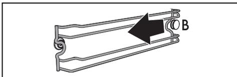
4. Repita las mismas operaciones para sacar el bastidor del otro lado.
