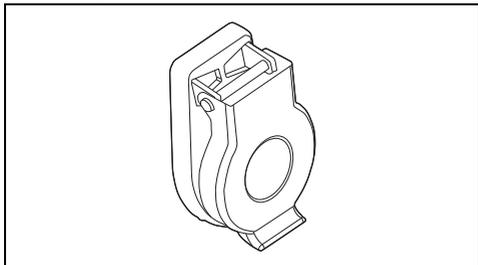
Útil para cerrar y proteger la toma de corriente de la sonda de temperatura, cuando esta última no se utiliza.
