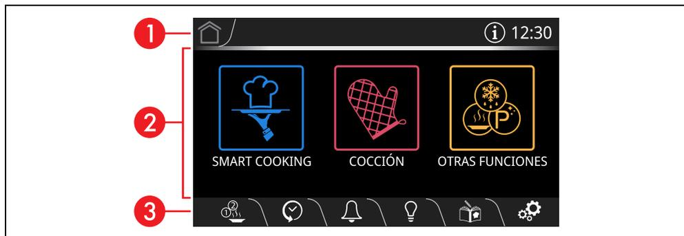
La pantalla muestra los parámetros y los valores relativos a la operación actualmente seleccionada. Para utilizar la pantalla solo hay que tocar las teclas «virtuales» y/o recorrer los valores indicados (en la imagen se representa la pantalla del menú principal).
