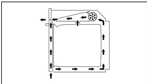
El ventilador procede a enfriar el aparato y entra en funcionamiento durante la cocción.
