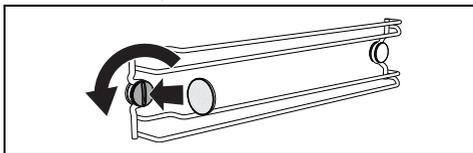
2. Tire del bastidor hacia el interior del horno hasta desengancharlo del alojamiento delantero A.
