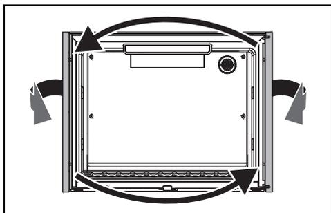
8. extraire le mécanisme de poussée de la porte et l'insérer dans le logement opposé.
