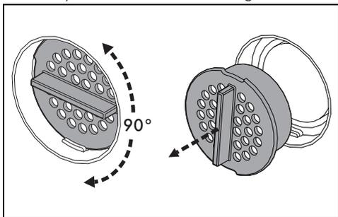
3. Remplacez le filtre à charbon actif par un filtre neuf.
