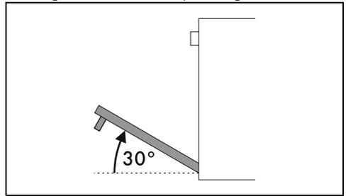
3. Para volver a montar la puerta coloque las bisagras en las hendiduras correspondientes situadas en el horno asegurándose de que las ranuras **A** se apoyen completamente en las hendiduras.
