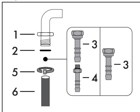
Enrosque cuidadosamente el conector de manguera 3 en el manguito del gas 1 (rosca 1/2" ISO 228-1) del aparato intercalando la junta 2. Según el diámetro del tubo del gas utilizado es posible enroscar también el conector de manguera 4 en el conector de manguera 3.
