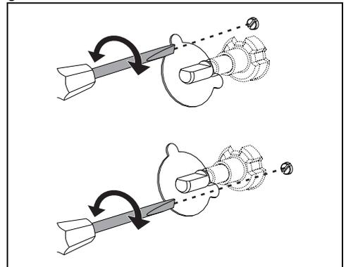
Encienda el quemador y póngalo en la posición de mínimo. Extraiga el mando de la llave del gas y gire el tornillo de regulación que se encuentra al lado de la varilla de la llave (según los modelos), hasta obtener una llama mínima regular.
