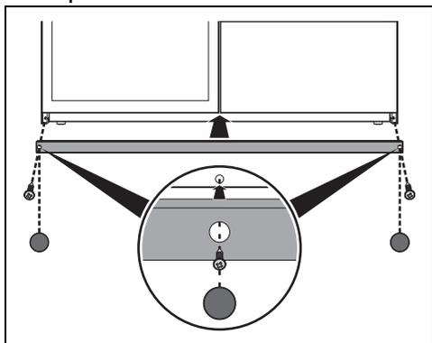
El zócalo debe estar siempre colocado correctamente y fijado al aparato.
