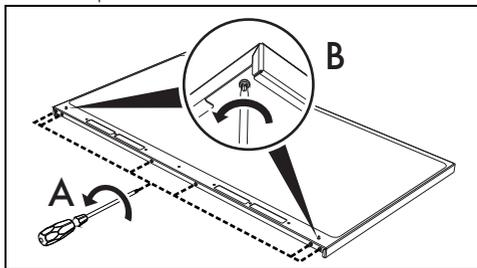
2. Coloque el respaldo en la encimera. Haga que correspondan las 6 ranuras inferiores del respaldo con los 6 tornillos de la parte trasera de la encimera, que han sido aflojados con anterioridad.
