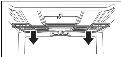
3. Una vez finalizadas las operaciones de limpieza, vuelva a colocar la resistencia en su posición original y gire el seguro para engancharla.
