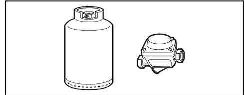
Utilice un regulador de presión y efectúe la conexión a la bombona de gas en conformidad con las disposiciones establecidas en las normas vigentes.
