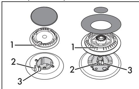
Antes de encender los quemadores de la encimera, verifique que los difusores de llama estén colocados en sus alojamientos con sus tapas correspondientes. Asegúrese de que los orificios 1 de los difusores de llama coincidan con las bujías 3 y los termopares 2.
