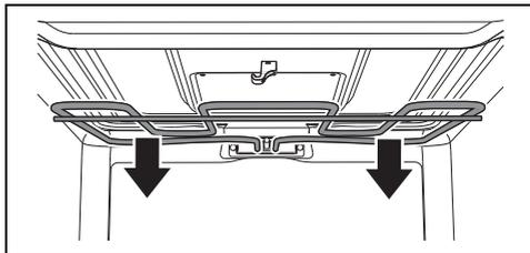
3. Al termine delle operazioni di pulizia riportare la resistenza in posizione e ruotare il fermo per agganciarla.
