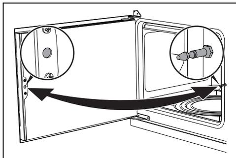
I forni multifunzione sono dotati di una porta con apertura a "bandiera". Per aprirle, tirare la maniglia della porta verso se stessi. Per
