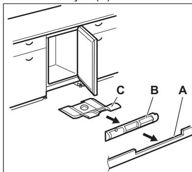
2. Limpe a grelha de ventilação. (Consulte "Limpar o filtro de ventilação".)
