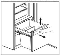
2. Spingere i binari nel mobiletto per evitare di danneggiare l'apparecchiatura in fase di chiusura della porta.
