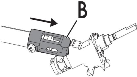
3. Volte a colocar o suporte "B" na posição inicial, de forma a cobrir completamente o injetor "C".
