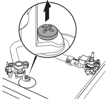
2. Quite el soporte del quemador y el tubo de conexión del gas correspondiente.
