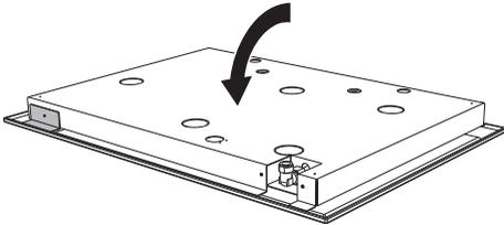
5. Solo modelos con UR lateral: quite el tornillo de fijación de la abrazadera.
