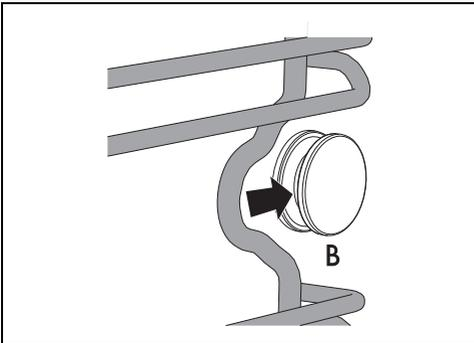
2. Reposicionar a parte dianteira da armação no alojamento A na parede lateral junto à abertura do compartimento de cozedura.
