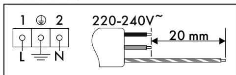
Cavo tripolare 3 x 1,5 mm<sup>2</sup>.
