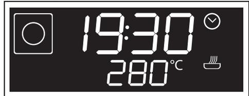
Dem Garvorgang geht eine Vorheizphase voraus, die es dem Gerät ermöglicht, die Gartemperatur schneller zu erreichen.
