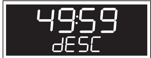
Nachdem der Entkalkungsvorgang abgeschlossen ist, gibt das Gerät ein akustisches Signal ab, und auf der Anzeige erscheint die Aufforderung zur Abgabe der Entkalkungslösung.
