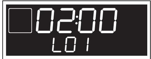
3. Drehen Sie den Temperaturknebel, um die Pyrolysedauer von einem Minimum von 2 Stunden bis zu einem Maximum von 3 Stunden einzustellen.
