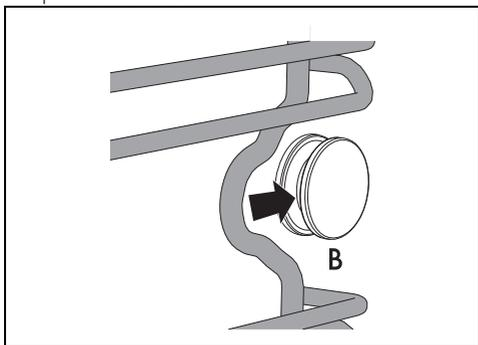
2. Riposizionare la parte anteriore del telaio nella sede A sulla parete laterale vicino all'apertura del vano cottura.
