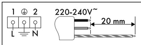
Cavo tripolare 3 x 1,5 mm<sup>2</sup>.
