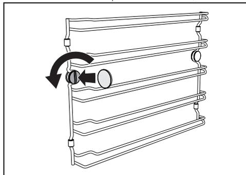
2. Tirare con attenzione il telaio verso il centro del vano cottura in modo da sganciarlo dalla sede anteriore A.
