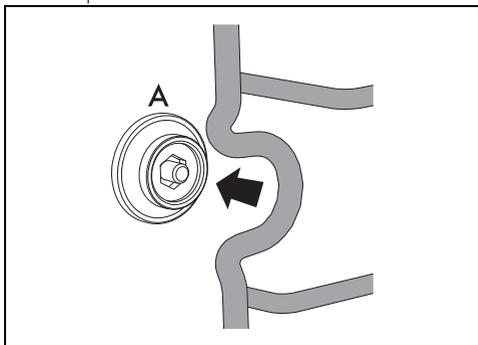
3. Avvitare il perno di fissaggio anteriore (è possibile aiutarsi con un utensile, ad esempio una moneta).
