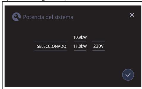
Deslice el dedo por los diferentes valores de potencia disponibles, que se pueden seleccionar en intervalos de 0,1 kW. (Función Eco-Logic Advance).
