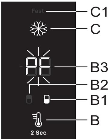
Falls die Temperatur im Gerät während eines Stromausfalls den Alarmwert erreicht, wird der Hochtemperaturalarm aktiviert, wenn die Stromversorgung wieder hergestellt wird. Ein akustischer Alarm ertönt und auf der Anzeige **B3** blinkt das Symbol **PF**.
