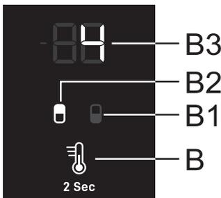
Bei diesem Modell können Sie zwischen der Einstellung der Temperatur des Kühlteils oder der Temperatur des Gefrierteils umschalten. Drücken Sie dazu die Taste **B** und halten Sie sie zwei Sekunden lang gedrückt, bis das Symbol für das gewünschte Fach aufleuchtet: **B1** für das Gefrierfach und **B2** für das Kühlfach.
