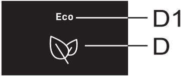
**Einschalten:** Um die **Eco** Funktion zu aktivieren, drücken Sie kurz die Taste **D**. Das Symbol **D1** leuchtet auf. Wenn diese Funktion aktiviert ist, arbeitet das Gerät unter optimalen Einstellungen.
