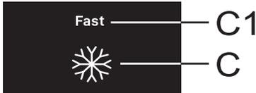
**Deaktivieren der Funktion:** Falls der Kühlteil aktiv ist (**B2** leuchtet auf), drücken Sie zuerst die Taste **C**, um zum Gefrierenteil zu wechseln (**B1** leuchtet auf) und drücken Sie danach die Taste **C**, um die Funktion zu deaktivieren.
