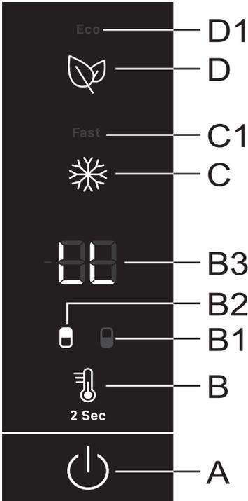
**Einschalten:** Um die Kindersperre zu aktivieren, drücken Sie die Tasten **A** und **D** und halten Sie sie zwei Sekunden lang gedrückt. Das Symbol **LL** erscheint kurz auf der Anzeige **B3**.
