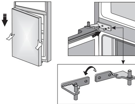
15. Positionieren Sie ordnungsgemäß die obere Tür, führen Sie den Steckverbinder (A) durch das Loch im oberen Scharnier (3) und befestigen Sie ihn mit den Schrauben (2). Halten Sie die obere Tür fest, während Sie diese positionieren. Verbinden Sie den Steckverbinder (A).
