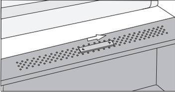
**Position des Feuchtigkeitsreglers rechts: geschlossen** – größere Feuchtigkeit im Fach.
