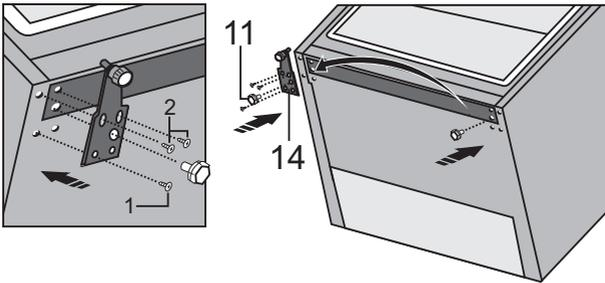
14. Setzen Sie die untere Tür auf das untere Scharnier und halten Sie sie fest. Drehen Sie das mittlere Scharnier um 180°. Bringen Sie die Unterlegscheibe in die richtige Position und stellen Sie die Position des mittleren Scharniers so ein, dass die untere Tür montiert und befestigt werden kann.
