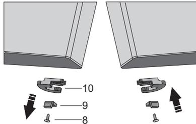
10. Entfernen Sie die mittlere Scharnierabdeckung und stecken Sie sie auf die gegenüberliegende Seite.
