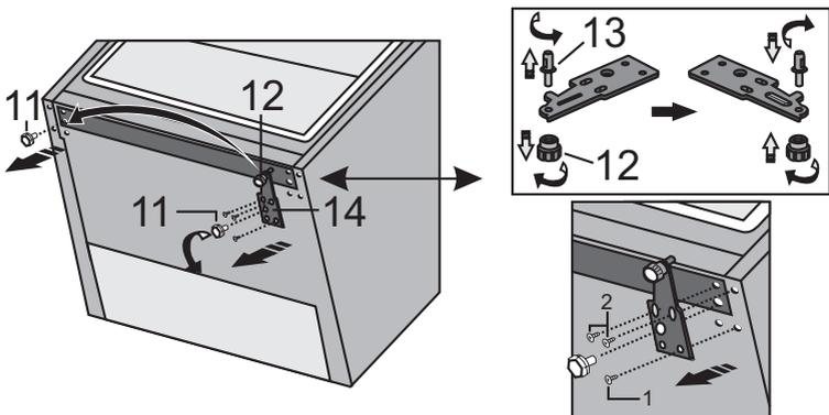
13. Befestigen Sie das Scharnier (14) mit den Schrauben auf der gegenüberliegenden Seite. Die Schrauben sollten in der in der Abbildung unten gezeigten Reihenfolge angebracht werden. Zuerst Schraube 1 festziehen, dann Schrauben 2. Dann die Stellfüße (11) anschrauben.
