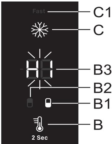
Falls die Temperatur im Gerät zu hoch ist, wird ein akustischer Alarm ausgelöst (**intermittierendes akustisches Signal**).
