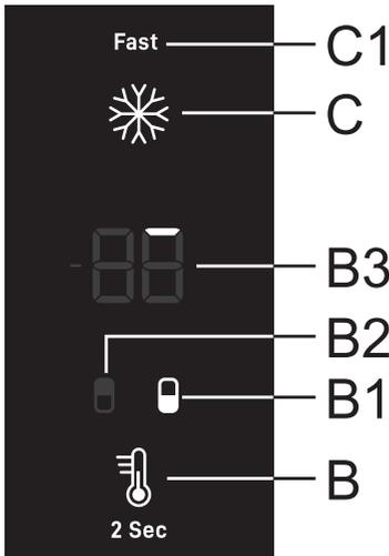
**Um die Funktion** Intensivgefrieren zu aktivieren, drücken Sie die Taste **C**. Es ertönt ein Piepton, die Anzeigen **B1** und **C1** leuchten auf.
