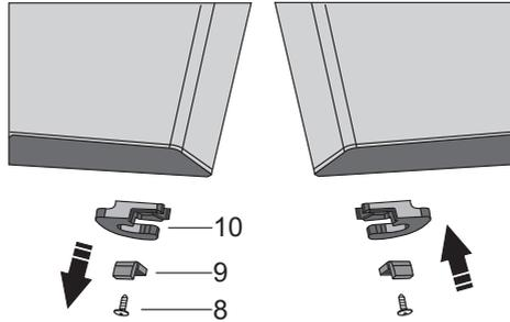
8. Lösen Sie die Schrauben des mittleren Scharniers und entfernen Sie sie. Demontieren Sie danach die untere Tür vom unteren Scharnier.
