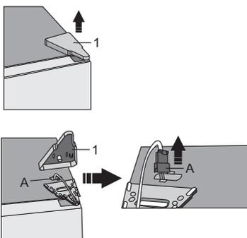
3. Lösen Sie die Schrauben (2) und entfernen Sie das Scharnier (3). Führen Sie den Steckverbinder (A) durch das Loch im Scharnier. Halten Sie die Tür dabei fest, damit sie nicht herunterfällt.
