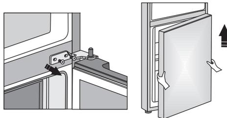
9. Legen Sie die untere Tür auf eine weiche Unterlage. Lösen Sie die Schraube (8) und entfernen Sie den Türhalter (10) und den Türanschlag (9). Verwenden Sie dann die Schraube (8), um den im Beutel enthaltenen Türhalter und Türanschlag (9) zu montieren. Bewahren Sie den Türhalter (10) für den Fall auf, dass Sie ihn später benötigen.
