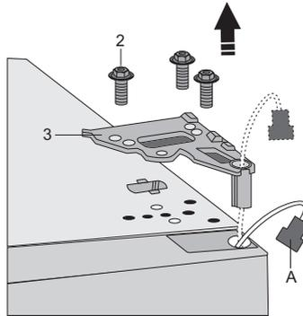
4. Entfernen Sie die obere Tür vom mittleren Scharnier, indem Sie die Tür vorsichtig nach oben anheben. Legen Sie die Gerätetür auf eine weiche Unterlage.
