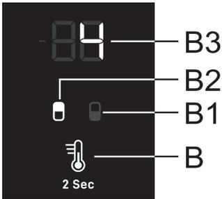
Die Temperatur im **Kühlteil** kann eingestellt werden, sobald das Symbol **B2** beleuchtet ist. Stellen Sie die gewünschte Temperatur durch kurzes Drücken der Taste **B** ein.
