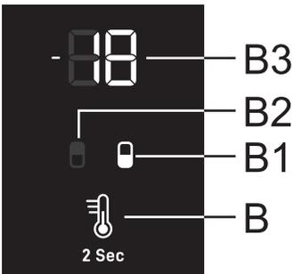
Die Temperatur im **Gefrierteil** kann eingestellt werden, sobald das Symbol **B1** aufleuchtet. Stellen Sie die gewünschte Temperatur durch kurzes Drücken der Taste **B** ein.
