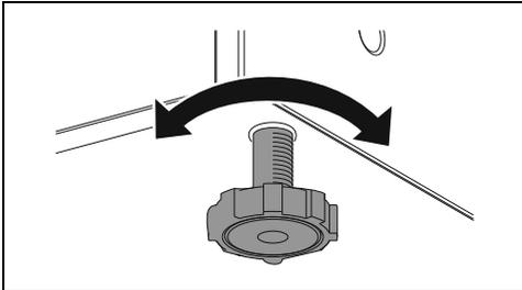
Die Stellfüße drehen, um das Gerät waagrecht zu nivellieren.
