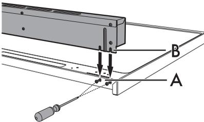
4. Fixez le dossieret sur la plaque en utilisant les 4 vis desserrées précédemment.
