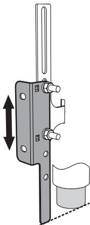
6. Considérez une distance de 50 mm du côté de l'appareil aux trous de la bride.
