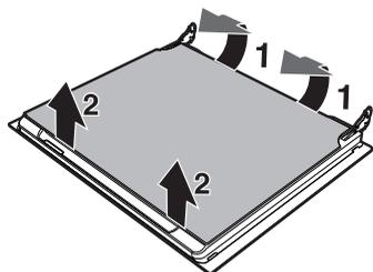
3. Démontez la vitre intermédiaire en la soulevant vers le haut. Suivez la même procédure pour la vitre intérieure, mais poussez la partie avant (2) vers l'intérieur de l'appareil.
