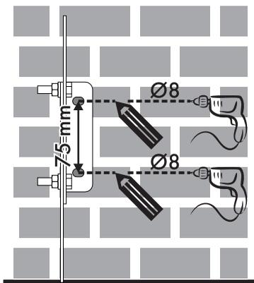
8. Après avoir réalisé les trous dans le mur, utilisez des chevilles avec des vis pour fixer la bride sur le mur.
