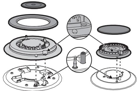
2. Remplacez les injecteurs en utilisant une clé à tube de 7 mm en fonction du gaz à utiliser (voir « Tableaux des caractéristiques des brûleurs et des injecteurs »).
