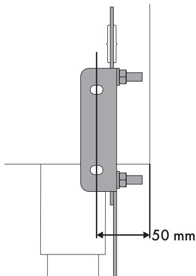
7. Déplacez la bride sur le mur et marquez la position des trous à réaliser dans le mur.
