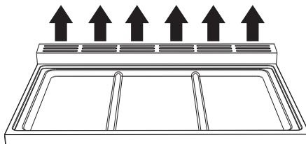
La turbine refroidit l'appareil et se met en marche durant la cuisson. Le fonctionnement de la turbine crée un flux d'air normal qui s'échappe par l'arrière de l'appareil et peut continuer pendant un court moment même après son extinction.
