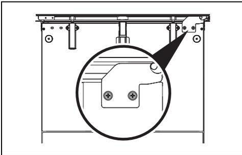
2. Die beiden Schrauben am oberen Scharnier losschrauben und entfernen.
