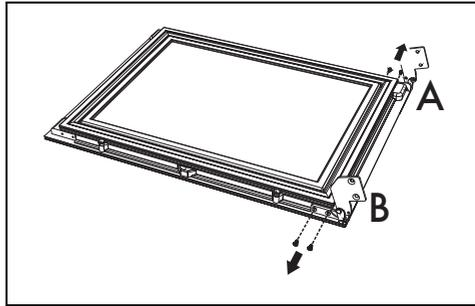
5. Die Scharniere auf der anderen Seite wieder verdreht anbringen. Das obere rechte Scharnier (A) unten links anbringen. Das untere rechte Scharnier (B) oben links anbringen.
