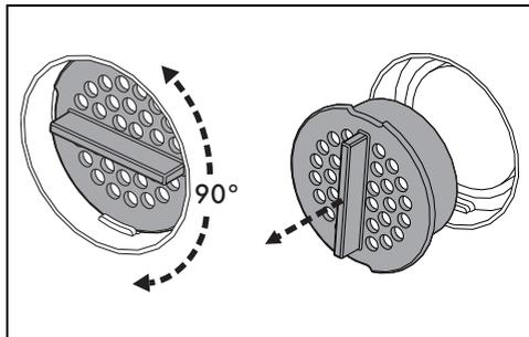
3. Den Aktivkohlefilter durch einen neuen ersetzen.
