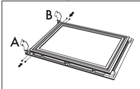
7. Den Mechanismus des Türdrückers entfernen und in die Aufnahme auf der gegenüberliegenden Seite stecken.
