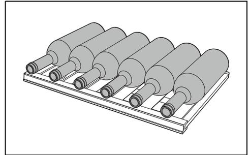
Auf den mittleren herausnehmbarem Einlegeboden können 9 Flaschen des Typs Bordeaux von 0,75 l angeordnet werden.
