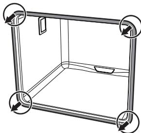
Per montare la guarnizione forno:
