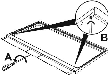
2. Coloque el respaldo en la encimera. Haga que correspondan las 6 ranuras inferiores del respaldo con los 6 tornillos de la parte trasera de la encimera, que han sido aflojados con anterioridad.
