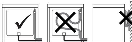
Efectúe la conexión a la red del gas utilizando un tubo de goma que reúna las características indicadas por las normas vigentes (compruebe que la sigla de esta norma esté impresa en el tubo).
