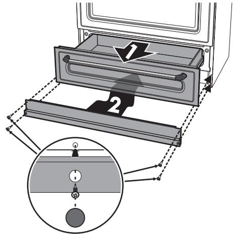
2. Coloque el zócalo en la parte inferior frontal del aparato.
