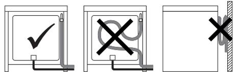
Efectúe la conexión a la red del gas utilizando un tubo de goma que reúna las características indicadas por las normas vigentes (compruebe que la sigla de esta norma esté impresa en el tubo).
