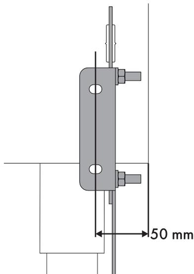
8. Después de haber hecho los agujeros en la pared, utilice tacos con tornillos para fijar la abrazadera a la pared.
