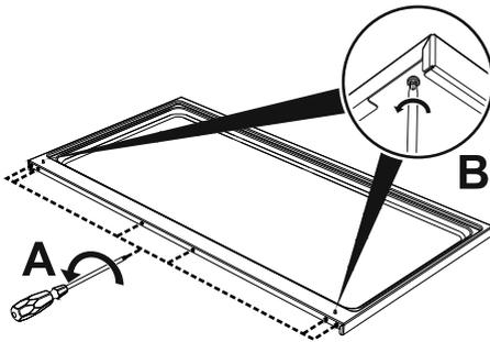
2. Coloque el respaldo en la encimera. Hacer que correspondan las 6 ranuras inferiores del respaldo con los 6 tornillos en la parte trasera de la encimera, que han sido aflojados con anterioridad.
