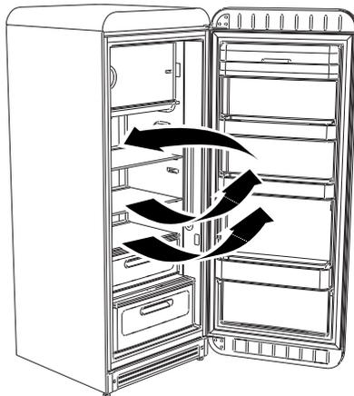
Система внутренней вентиляции позволяет быстрее охлаждать продукты и обеспечивает равномерное охлаждение внутри прибора.
