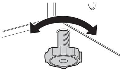
Для выравнивания прибора по горизонтали следует использовать эти ножки.
