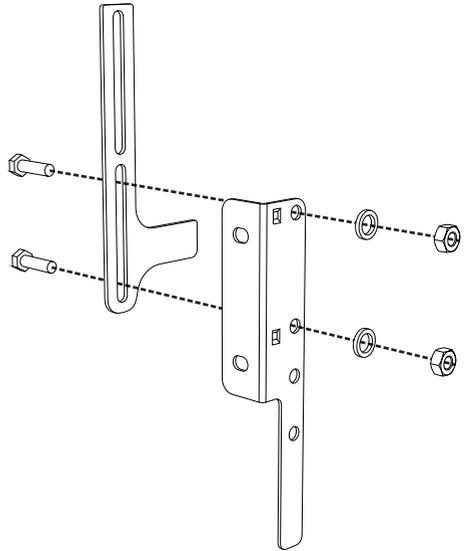
4. Alignez la base du crochet de la bride de fixation sur la base de la coupe de la plaquette de fixation au mur.
