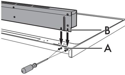
4. Fixez le dossieret sur le plan en utilisant les 4 vis desserrées précédemment.
