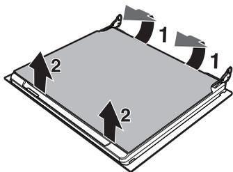
3. Retirer la vitre intermédiaire en la soulevant vers le haut et suivre la même procédure pour la vitre intérieure, mais en prenant soin de pousser la partie avant de la vitre (2) vers l'intérieur de l'appareil.
