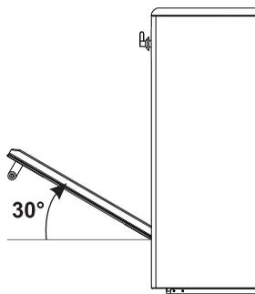
3. Pour remonter la porte, introduisez les charnières dans les fentes prévues à cet effet sur le four en vous assurant que les rainures **A** sont complètement posées contre les fentes. Abaissez la porte puis, après l'avoir positionnée, sortez les pivots des trous des charnières.
