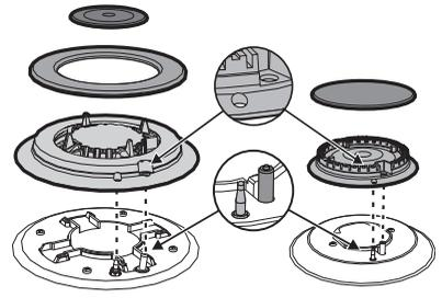
2. Remplacez les injecteurs en utilisant une clé à tube de 7 mm en fonction du gaz à utiliser (voir les « Tableaux des caractéristiques des brûleurs et injecteurs »).
