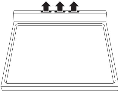
La turbine refroidit l'appareil et entre en fonction pendant la cuisson.
