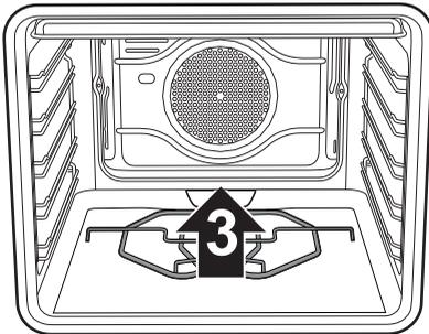
Vuelva a colocar el fondo de apoyo de la piedra para pizza, empujándolo hasta el tope contra la parte trasera del horno y haga que descienda de manera que la plaquita de la resistencia encaje con la base misma.
