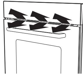
El ventilador enfría el aparato y entra en funcionamiento durante la cocción.
