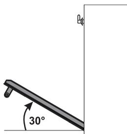
3. Para volver a montar la puerta coloque las bisagras en las hendiduras correspondientes situadas en el aparato asegurándose de que las ranuras **A** se apoyen completamente en las hendiduras. Baje la puerta y, una vez posicionada, quite los pernos de los agujeros de las bisagras.
