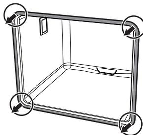
Per mantenere pulite le guarnizioni della porta utilizzare una spugna non abrasiva con acqua tiepida. Le guarnizioni devono essere morbide ed elastiche.
