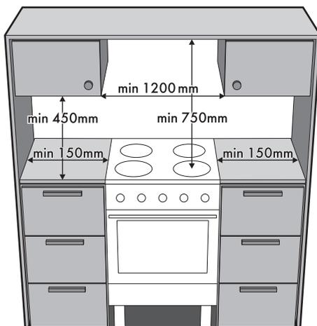
Qualora venga installata una cappa aspirante sopra il piano cottura, fare riferimento al manuale istruzioni della cappa per rispettare la distanza corretta.
