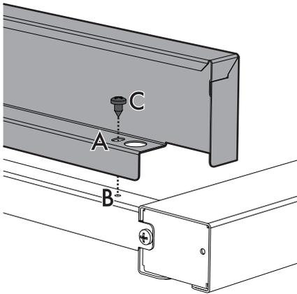
2. Fissare l'alzatina al pianale avvitando le viti **C**.
