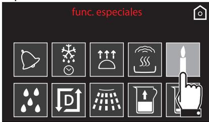
2. Pulse el símbolo
