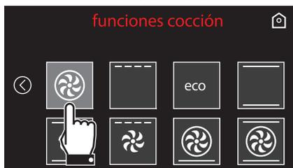
4. El aparato iniciará la fase de precalentamiento. En la pantalla se muestra la función seleccionada, la temperatura preprogramada, la hora actual y el avance de la temperatura alcanzada (precalentamiento).
