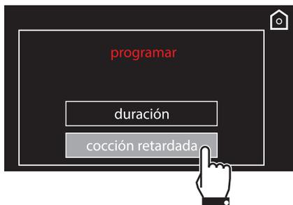
15. Teclee la hora de fin de cocción deseada (por ejemplo a las 13:30: toque primero la casilla de las horas, seguidamente los números 1 y 3; toque la casilla de los minutos y seguidamente los números 3 y 0).
