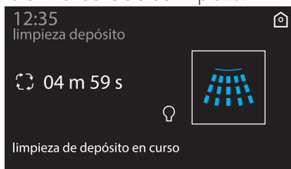
Al terminar el proceso de limpieza interviene una señal acústica y en la pantalla aparece la pantalla de expulsión de la mezcla.
