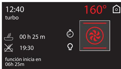
6. Según los valores programados, el aparato comenzará la función seleccionada para terminarla a la hora fijada (añadirá de manera automática un tiempo de 10 minutos para el precalentamiento).
