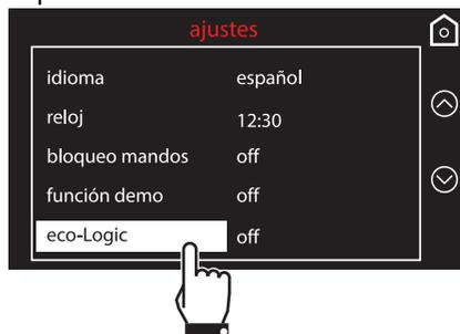
2. Para confirmar la activación de la función eco-logic seleccione **sí**.
