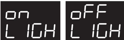
Para impedir que el aparato desactive la lámpara después de un minuto ponga en **OFF** esta función.
