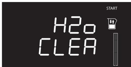
2. Presione el mando de las funciones para confirmar la elección de la función. La pantalla muestra la petición de carga del depósito.
