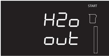
**i** Esta función permite vaciar manualmente el depósito.
