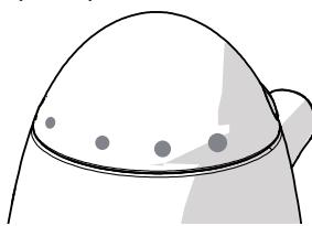
Позволяет регулировать скорость вращения ножей, если используется погружной блендер. Регулировка скорости происходит ступенчато: шарики на селекторе постепенно увеличиваются, обозначая увеличение скорости.
