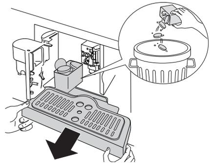
**! Achtung!** Immer dann wenn die Abtropfschale herausgezogen wird, MUSS auch der Kaffeesatzbehälter geleert werden. Wird dieser Vorgang nicht durchgeführt, kann dies eine Verstopfung der Kaffeemaschine bewirken.
