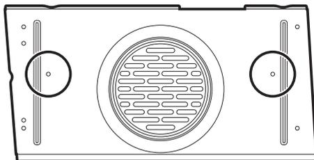
4. Sostituire il deflettore con il nuovo deflettore autopulente (**2**): fissarlo alla parete posteriore del vano forno tramite le apposite viti precedentemente rimosse.
