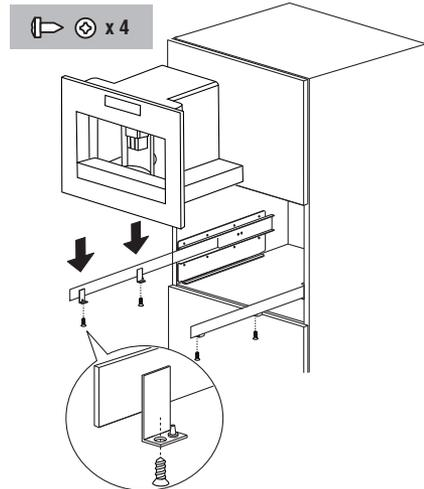
Coloque el aparato en las guías, asegúrese de que los pernos encajen correctamente en los huecos correspondientes y, a continuación, fíjelo con los tornillos de la dotación.
