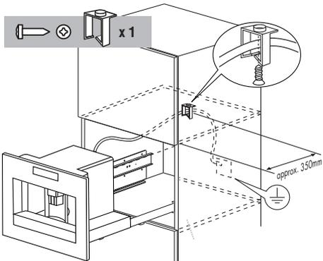
Utilice la grapa correspondiente para fijar el cable de alimentación para evitar que el cable quede atrapado al sacar o al colocar el aparato. El cable de alimentación debe ser lo suficientemente largo para poder sacar el aparato del mueble para llenar el depósito con los granos de café.
