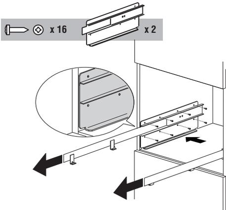
Coloque las guías en las superficies laterales del mueble siguiendo las indicaciones de la figura. Fije las guías con los tornillos correspondientes y luego sáquelas del todo.
