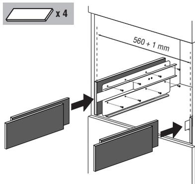
Si el plano del mueble no está suficientemente recto, para nivelar correctamente el aparato sitúe los distanciadores de la dotación bajo el soporte o en los lados.
