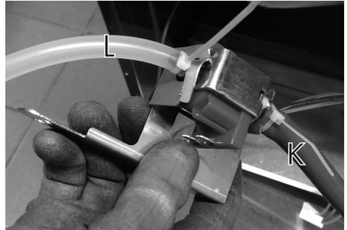
7. Collegare il tubo dell'apparecchio "K" alla estremità "H2" della pompa e collegare il tubo in dotazione con il kit "L" all'estremità "H1" (vedi passo n°4). Successivamente fissarli con fascette in dotazione.
