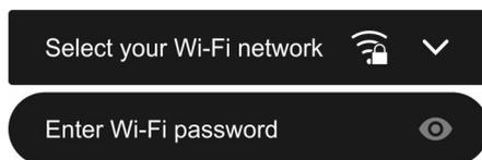
**i** L'appareil supporte des noms de réseau (SSID) jusqu'à 32 caractères (espaces compris) et sélection de sécurité WPA2 (et non WEP ou WPA).
