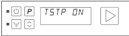
**En posición "on" = temperatura mínima de aclarado** según se haya establecido (ver más arriba, temperatura calentador), independientemente de la temperatura del agua que entra, la duración nominal del ciclo podría alargarse unos segundos.
