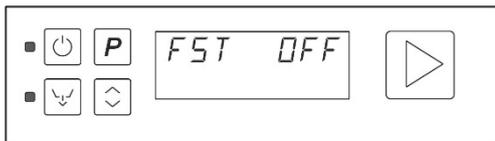
**Puesta en marcha fast (FST):** permite encender el aparato en un tiempo inferior al estándar; comporta un mayor consumo de agua en la primera puesta en funcionamiento.
