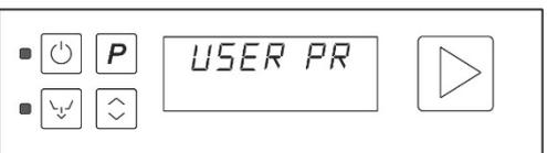
Solamente el programa **USER**. se puede personalizar. Si observando secuencialmente los parámetros de configuración se ve **USER.P1, P2...** seguido de dos guiones (por ej. **P2--**). Apretar repetidas veces el botón P hasta que se lea **USER** seguido de la duración (por ej. **USER. 03.10**).
