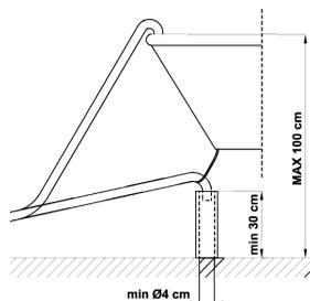
Im Falle von horizontal angeordneten Verlängerungsschläuchen, die eine Länge von maximal 3 m haben dürfen, muss man den Ablaufschlauch auf einer Höhe von maximal **85 cm** vom Boden anordnen.
