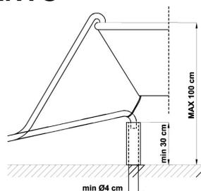
Quando existirem mangueiras com extensões dispostas horizontalmente, num máximo de 3 m, posicione a mangueira de escoamento a uma altura máxima de **85 cm** do chão.
