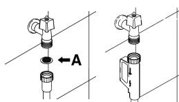
В моделях с системой ACQUASTOP фильтр встроен в резьбовое кольцо.
