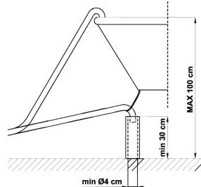
При наличии горизонтально уложенных удлинительных шлангов с максимальной длиной 3 м разместите сливной шланг на высоте, составляющей максимум **85 см** от пола.
