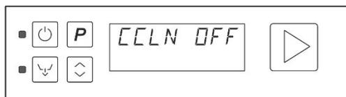
L'attivazione di questa opzione prevede lo scarico totale dell'acqua in vasca ed il suo successivo riempimento con acqua pulita ad ogni ciclo di lavaggio. La durata di questa operazione dipende dalla temperatura dell'acqua di alimentazione.
