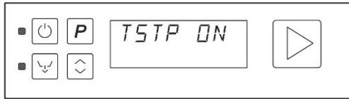
**Configurado en "on" = temperatura mínima de lavado y enjuague para cuba y calentador según lo establecido,** independientemente de la temperatura del agua de entrada; la duración nominal del ciclo podría extenderse unos segundos.
